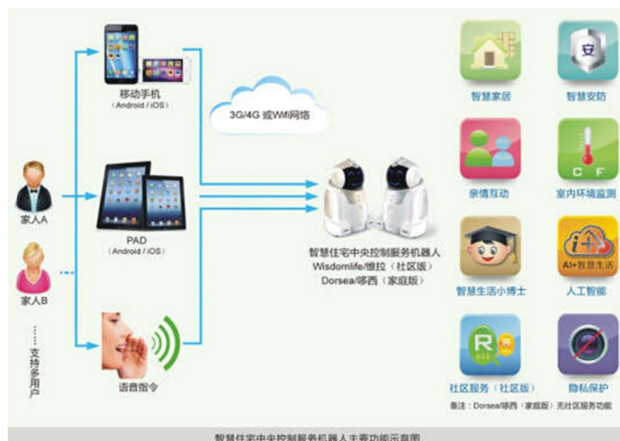
图1 智慧住宅中央控制服务机器人主要功能示意
