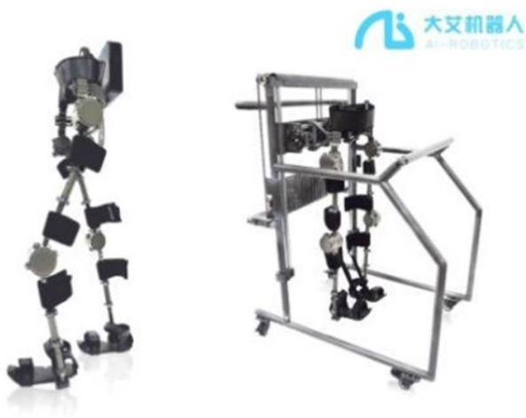
图1 AiWalker移动台架型下肢外骨骼机器人
